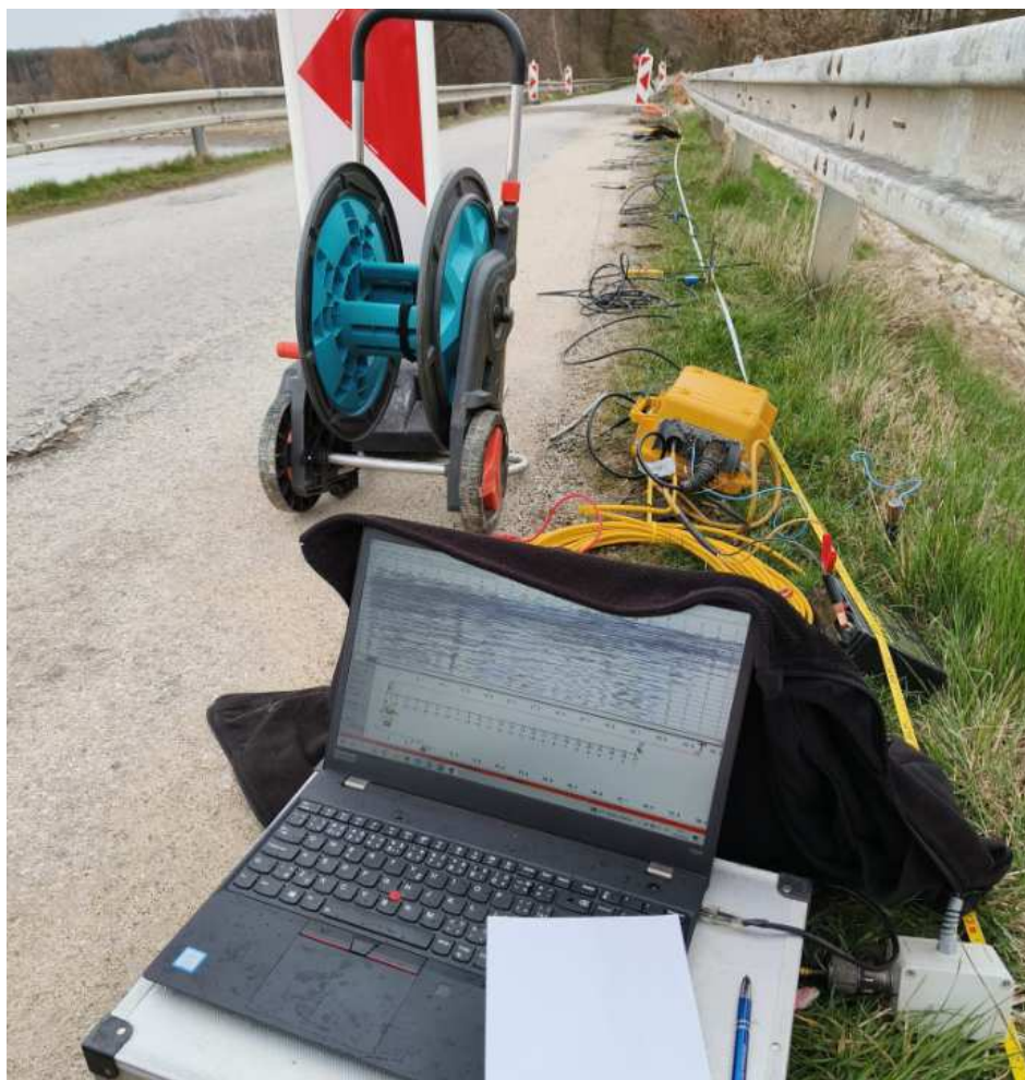
Foto5: Měření MRS (mělké refrakční seismiky)
