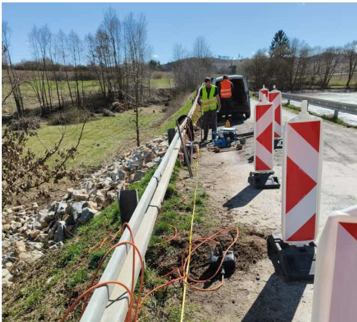
Foto2: Realizace geofyzikálního profilu 1
