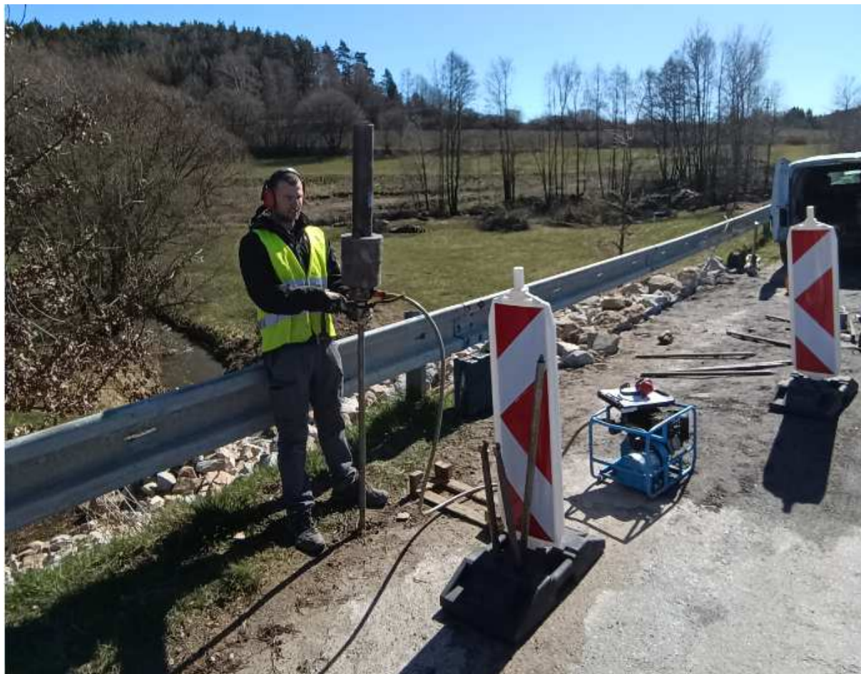
Foto3: Realizace dynamické penetrační sondy DPH3
